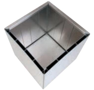
Hier sehen Sie den doppelwandigen Aufbau des Pflanzkastens **Duplex Max** im Anschnitt. Die innen liegenden Paneele bewahren einen Abstand von ca. 26 mm zur Außenhülle.
