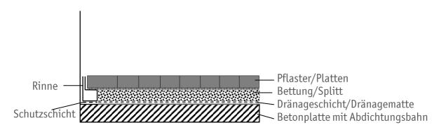
Vor Beginn des Rinneneinbaus sollte der Ablauf sorgfältig geplant werden. Unter der Dränagerinne muss eine Schutzschicht aus geeignetem Material (z.B. EPDM-Folie) in Breite der Rinne verlegt werden, um die Abdichtung der Betonfläche nicht zu beschädigen.
