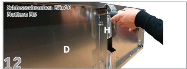
12 Füße montieren: Die drei Füße H am Unterboden D festschrauben
